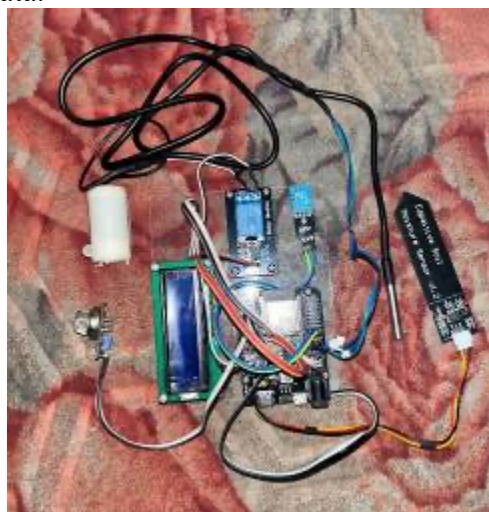
Gambar 1. Alat Monitoring Kualitas Udara dan Tanah pada Tanaman Berbasis IoT
